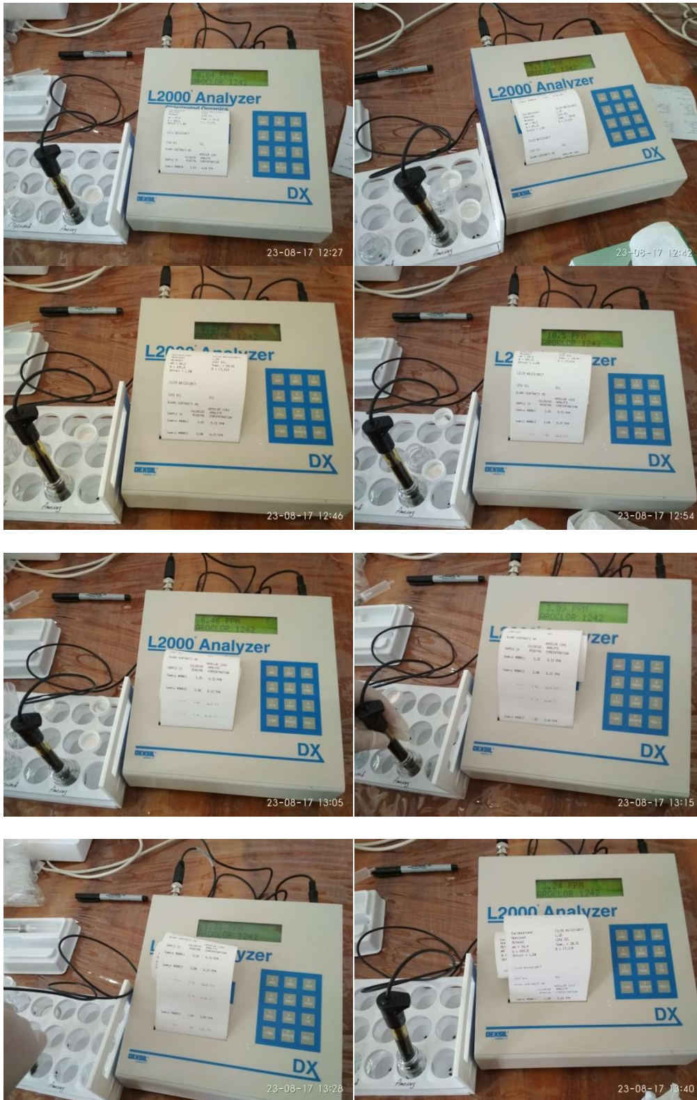
Рисунок 33. Автоматически созданные результаты анализов, проведенных анализатором L2000DX.
