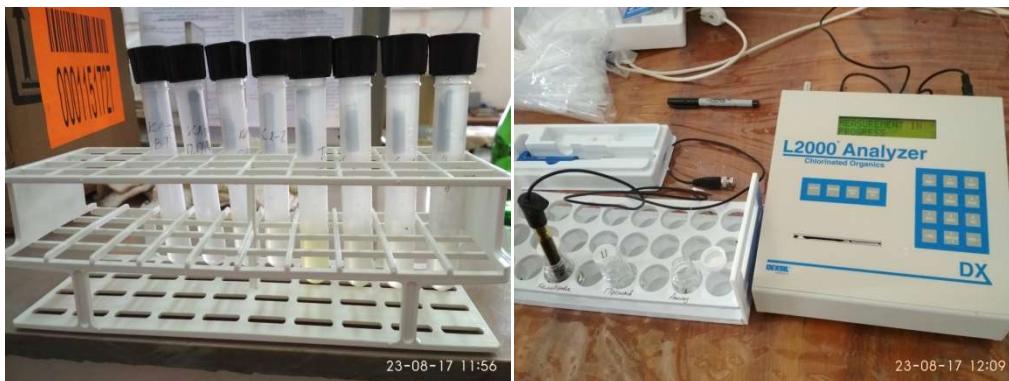
Рисунок 31. Образцы кабельного и трансформаторного масел, подготовленные к тесту с помощью анализатора L2000 DX.
