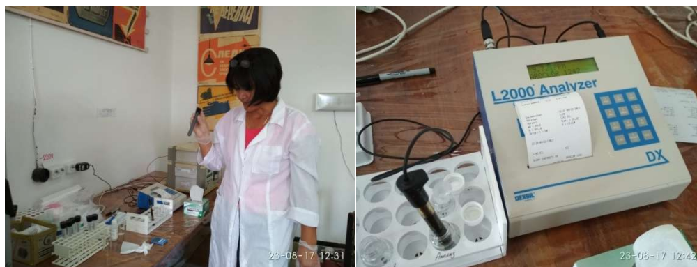
Рисунок 32. Выполнение анализа масла на ПХБ персоналом Токтогульской ГЭС.
